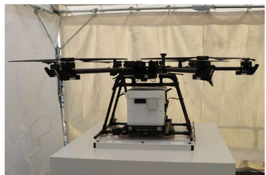
<ドローンの下についている白い箱に バッテリーが入っています>
