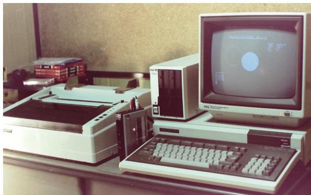
PC-8801の構成。5インチフロッピーディスク(中央上)とカセットテープ(中央下)が記憶装置 (撮影：山本威一郎)
